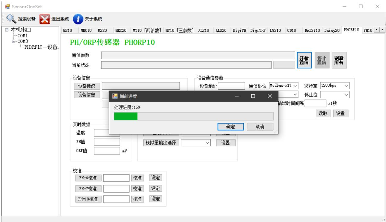
(3) 双击窗口左侧串口下列出的设备“PHORP10-设备地址……”，其通讯参数会自动列到右侧的“电脑通讯设置”中。点击右侧的“开始”按钮，软件开始于模块进行通讯。
