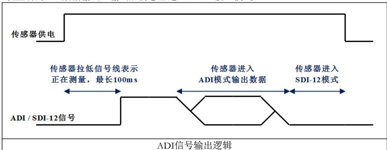
ADI 接口数据流输出为串行 TTL 信号输出标准 (0-3.6V), 以 ASCII 码表示字符, 串行波特率 1200bps, 无校验, 8 个数据位, 1 个停止位。数据输出后, 传感器进入休眠功耗。当需要传感器再次主动输出数据时, 需断开传感器电源, 然后重新上电。传输示例如下图
