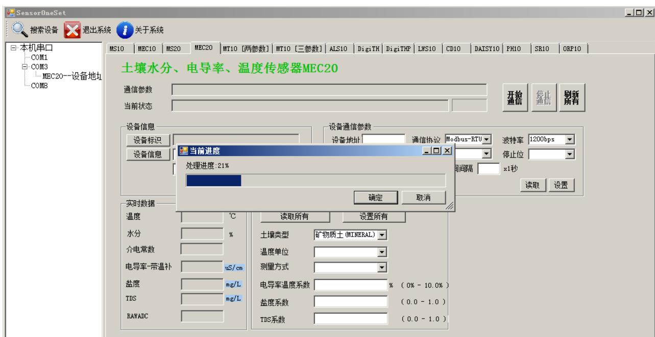
(3) 双击窗口左侧串口下列出的设备“MEC20-设备地址……”，其通讯参数会自动列到右侧的“电脑通讯设置”中。点击右侧的“开始”按钮，软件开始于模块进行通讯。
