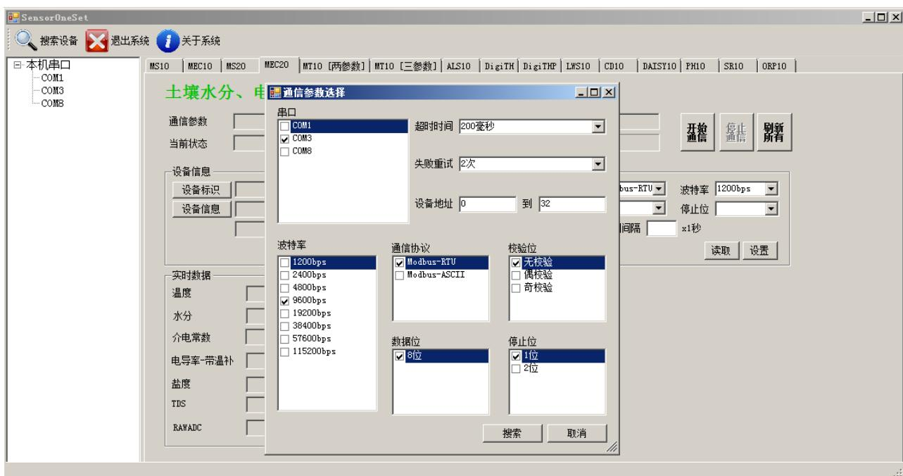
(2) 在“通信参数选择”对话框中选择合适的通讯参数。并点击“搜索”按钮。搜索到的设备会列在相应的串口下。如下图。
