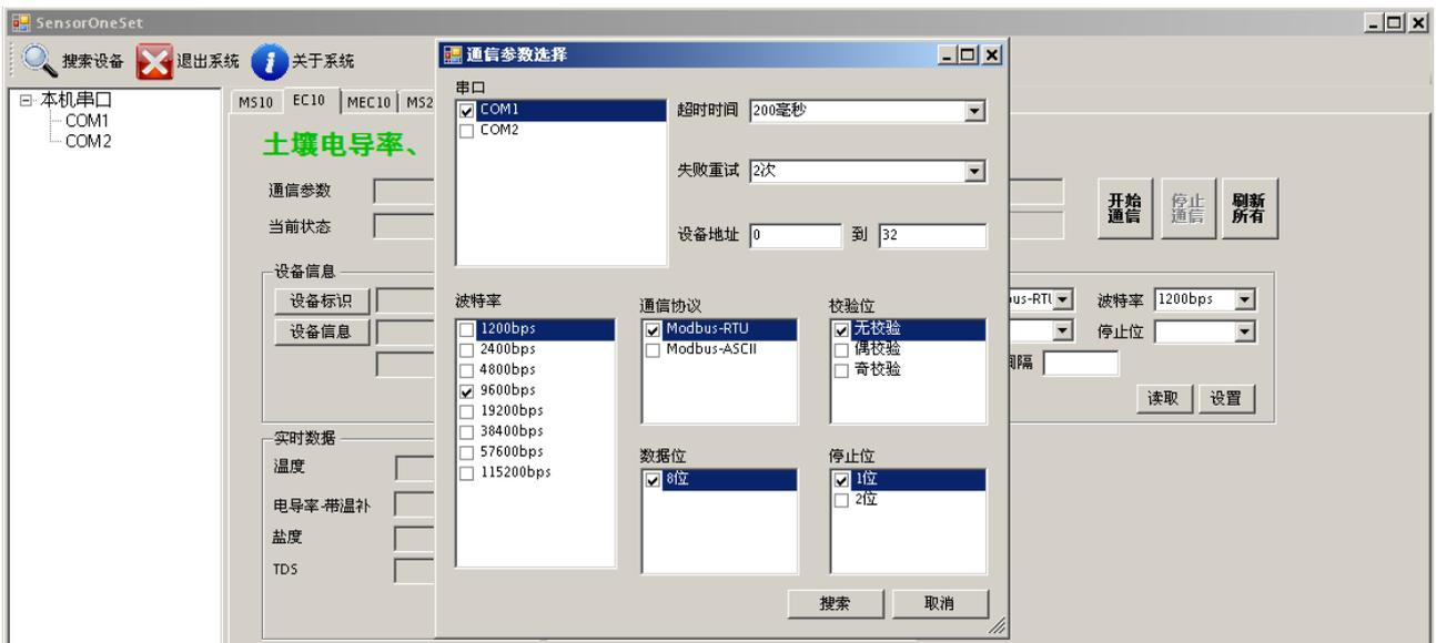
(2) 在“通信参数选择”对话框中选择合适的通讯参数。并点击“搜索”按钮。搜索到的设备会列在相应的串口下。如下图。
