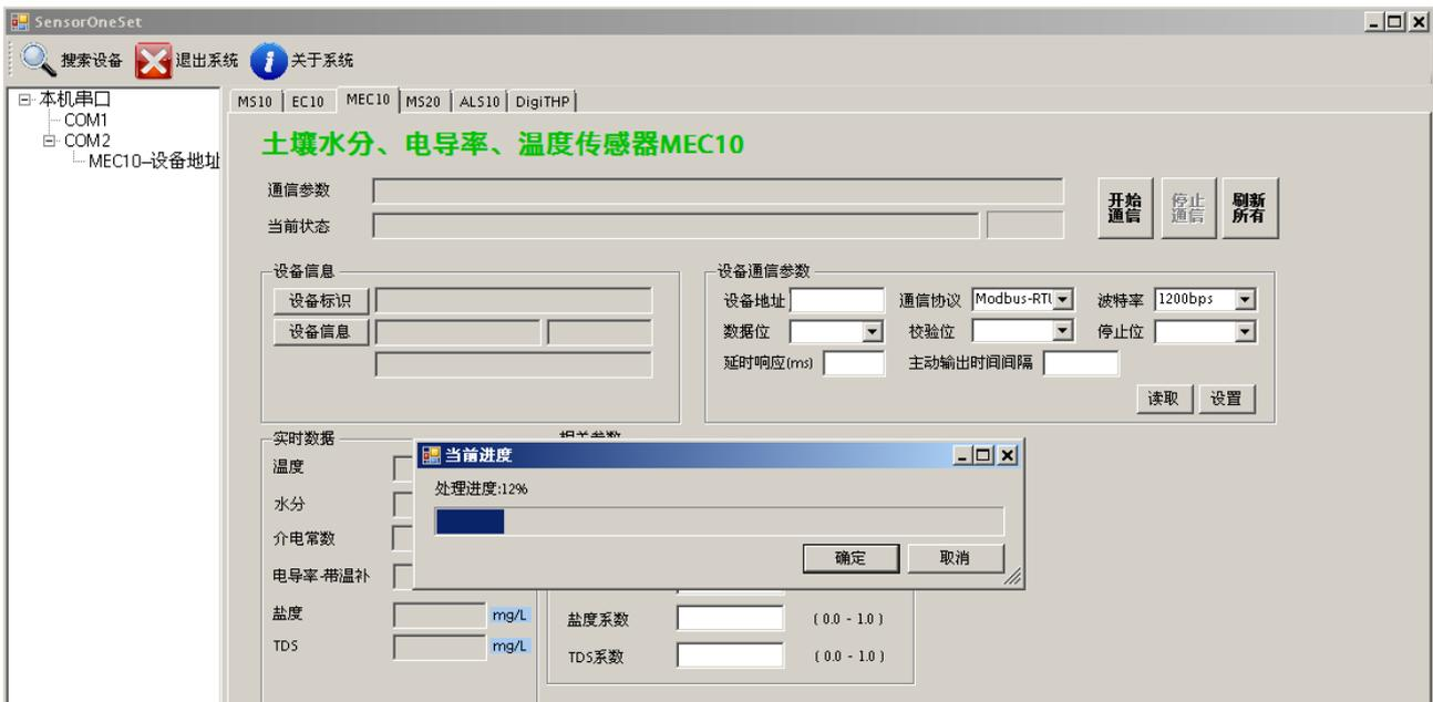
(3) 双击窗口左侧串口下列出的设备“MEC10-设备地址……”，其通讯参数会自动列到右侧的“电脑通讯设置”中。点击右侧的“开始”按钮，软件开始于模块进行通讯。
